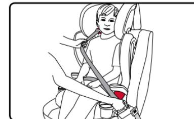
**REMARQUE :** La partie baudrier de la ceinture de sécurité du véhicule doit être passée sous l'accoudoir du côté de la boucle.
