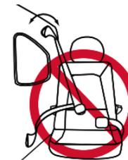
**Ceinture sous-abdominale/baudrier avec un point d'ancrage supérieur ou inférieur sur la porte du véhicule.**
